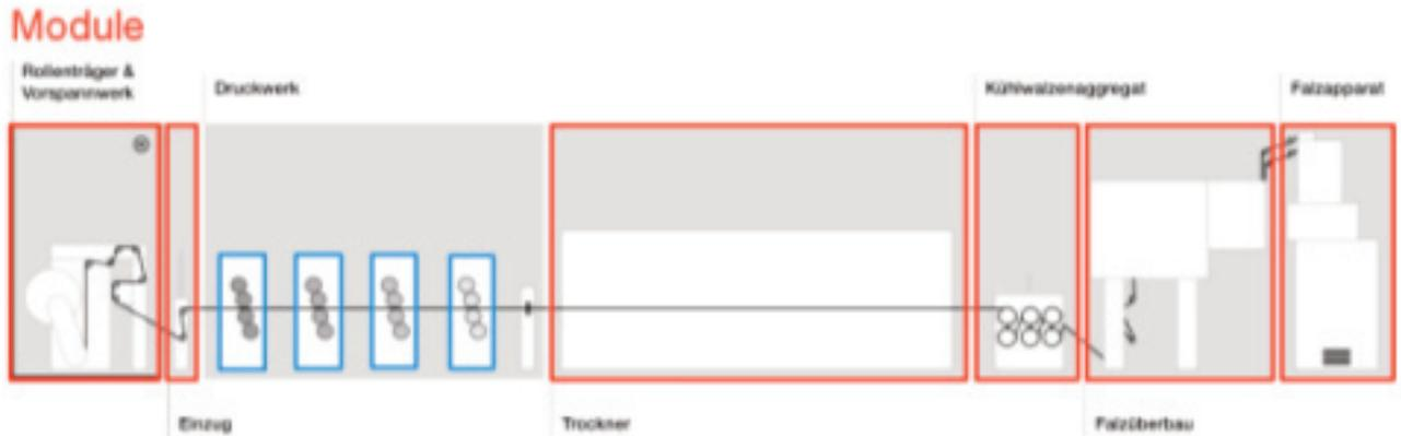
Bild 1: Eine Druckmaschine setzt sich aus verschiedenen Modulen zusammen, wobei es sich bei den Druckwerken um mehrere Module handelt, die alle die gleiche Funktion haben.
