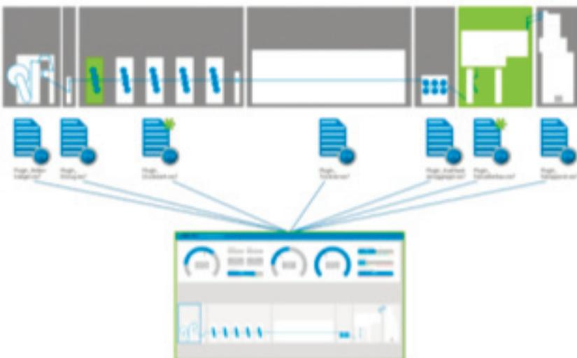
Wird die Druckmaschine um weitere mechanische Module erweitert, so lässt sich diese Änderung leicht und schnell auch in der modularen Prozessvisualisierung realisieren.
